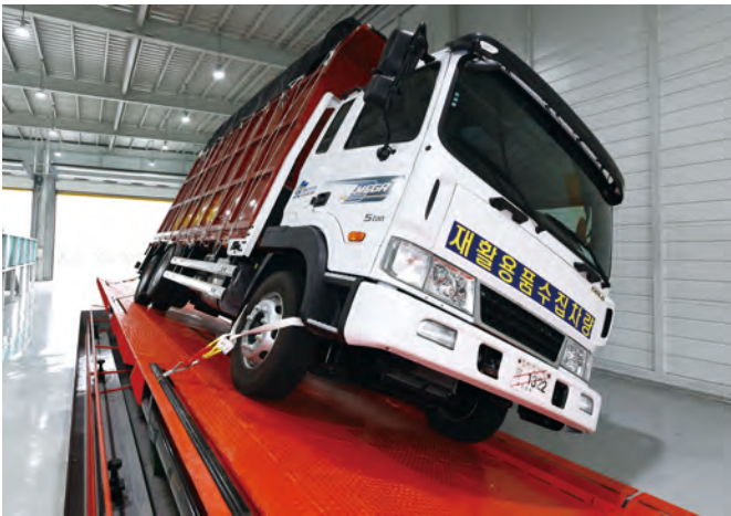
▲ 최대안전경사각도 시험 시연 모습
